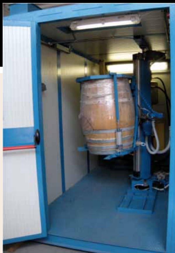
FIGURA 4 - Sistema automatizzato per il trattamento delle barriques
